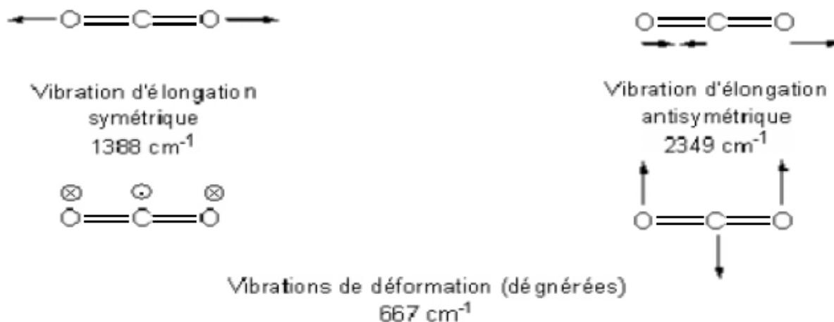
**Figure I. 4:** Les quatre modes propres de vibration du dioxyde de carbone.
