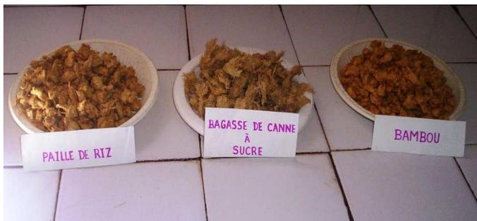
Figure 02: Fibres cellulosiques après séchage à l'étuve 105°C
