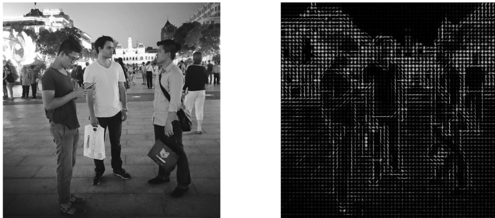
FIGURE 7.10 – Détection des piétons avec des histogrammes de gradients orientés
