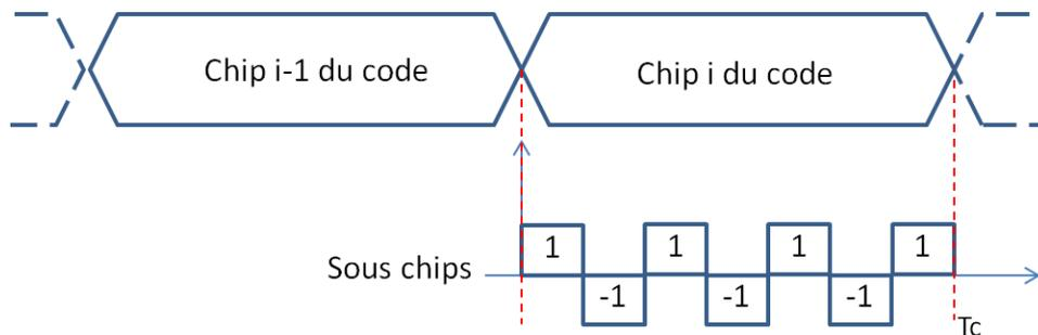
Figure I-7 : schéma de la modulation  $BCS([1,-1, 1,-1, 1,-1,1], f_c)$
