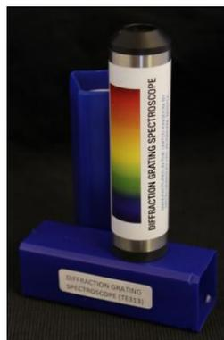
**Photo 10 : Spectroscope à main**
