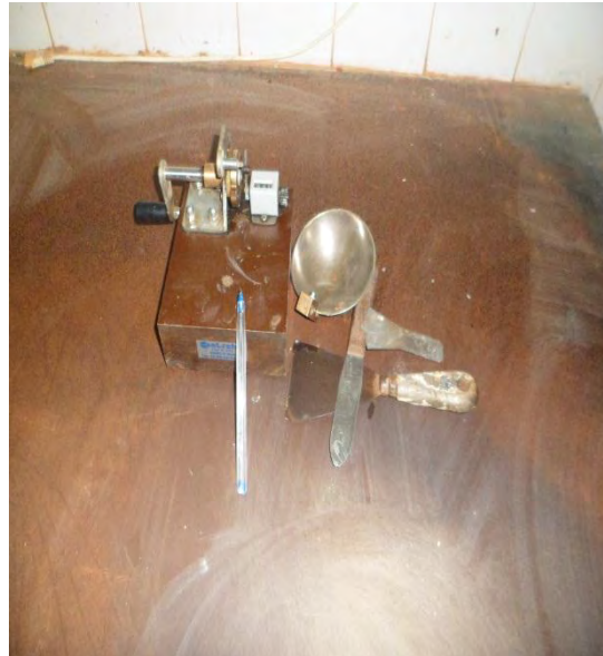
Figure 6: Illustration de la coupelle de Casagrandé
