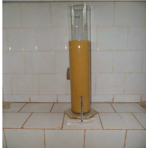
Figure 5: Illustration de la densimétrie
