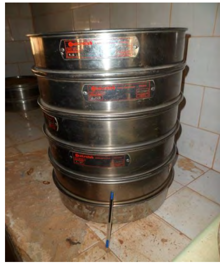
Figure 4: Les séries de tamis
