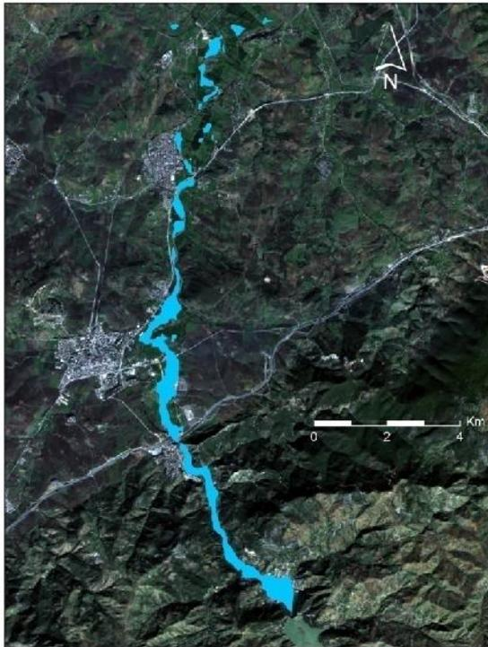
**Figure 6.7.** Inondation prévue 15 min après la rupture
