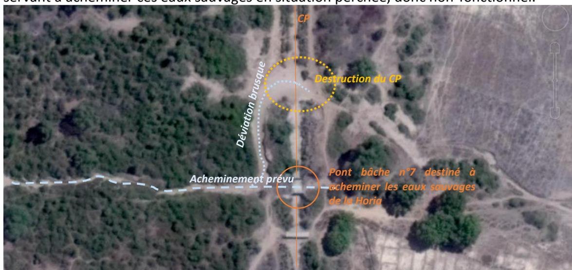
Photo 5: Contournement des eaux sauvages de l'Horia au niveau du pont bêche n°7
