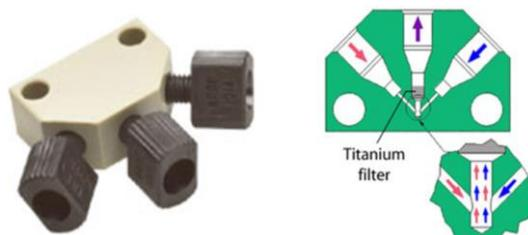
**Figure 106** Microréacteur utilisé pour l'observation d'intermédiaires en présence d'éthylène
