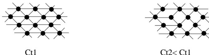
Figure n°03 : Représentation schématique de la connectivité d'un réseau poreux
