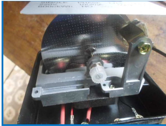
Figure 14 : montage interne d'un compteur électromécanique
