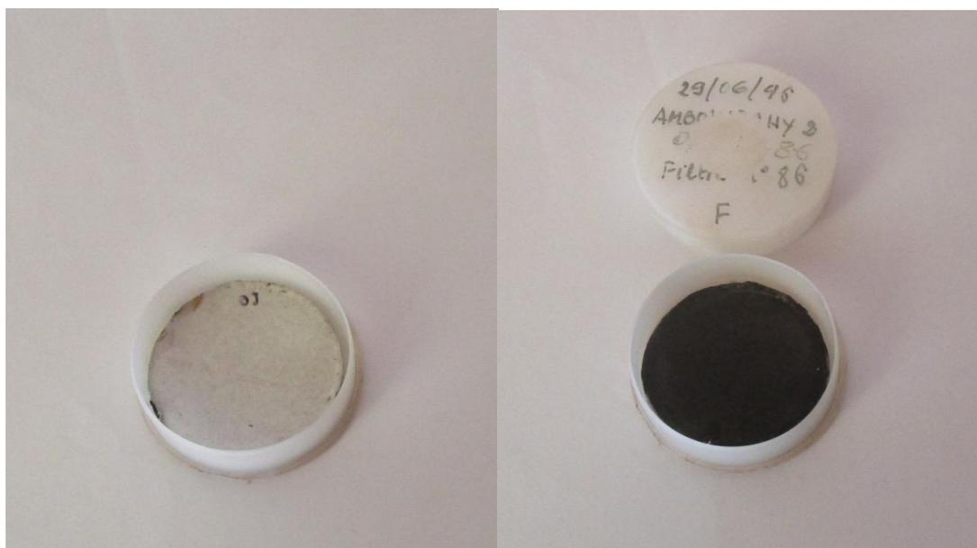
Figure 7- Le filtre avant et après le prélèvement d'air dans le tunnel d'Ambohidahy (29/06/1996)
