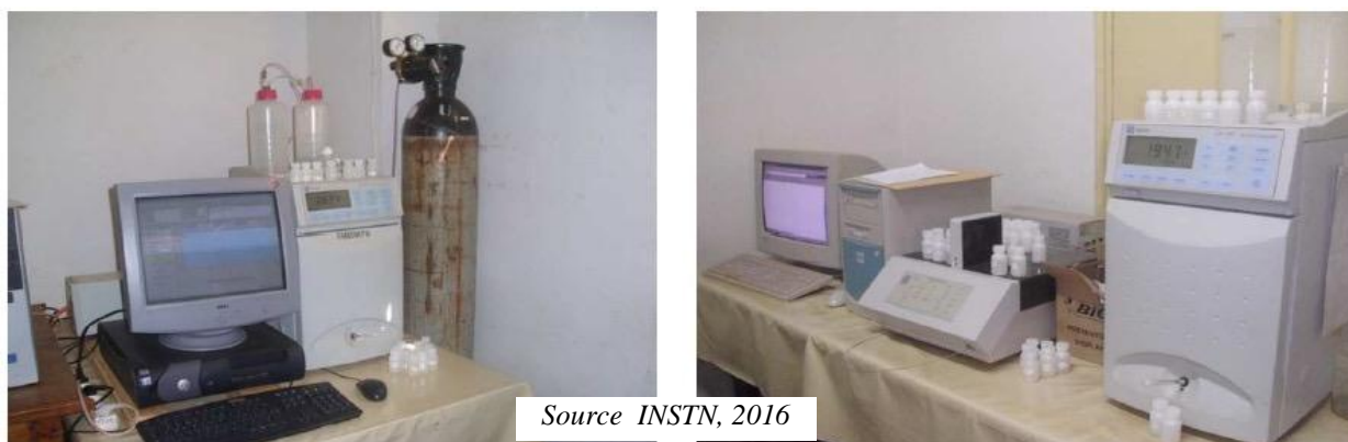
Figure 15- Les chaînes d'analyses par chromatographie anionique (à gauche) et cationique (à droite)
