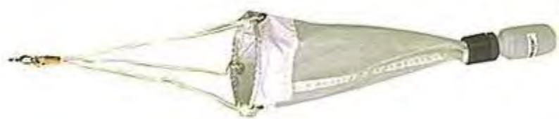
**Figure 4. Filet simple à plancton utiliser dans les AMP**
