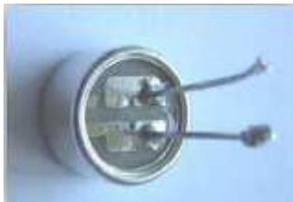
Figure 3 : Photo du microphone électret
