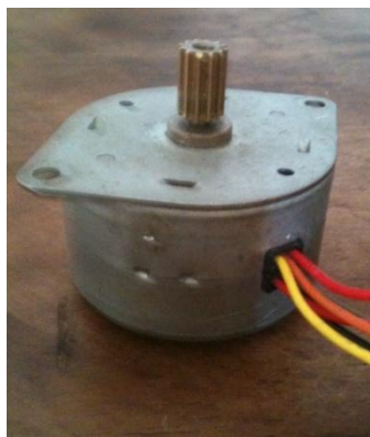
Photo II : Moteur pas à pas unipolaire 4 phases
