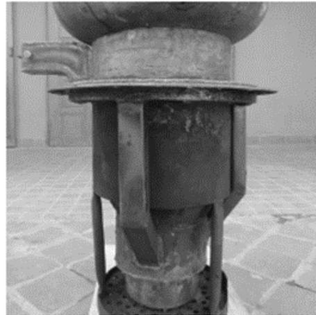
FIG 2 : Photographie de la chambre de réaction
