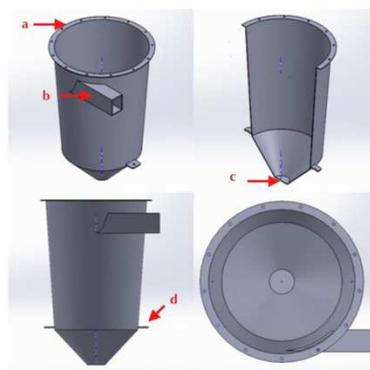
FIG 4 : Différentes vues de l'enveloppe avec : (a) bride, (b) sortie du syngas, (c) récupération du cendre et (d) fixation avec le cadre
