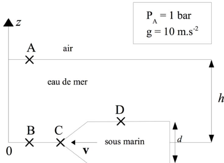
On considère un sous-marin circulant à la vitesse  $v = 15$  km.h<sup>-1</sup> dans l'eau de mer ( $\rho = 1040$  kg.m<sup>-3</sup>) à la profondeur  $h = 18$  m (voir Fig. ??).
