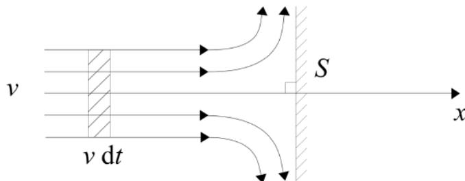
FIGURE 7 – Rencontre d'un fluide avec un obstacle.
