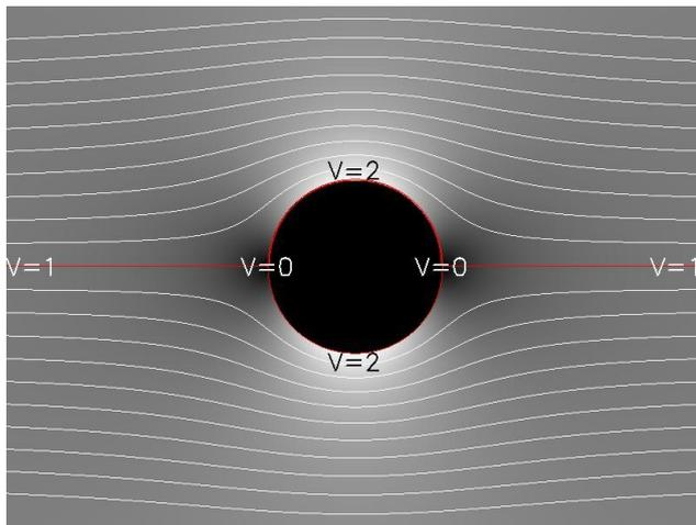
En niveaux de gris: la norme  $\|\mathbf{v}\|$  du vecteur vitesse  $\mathbf{v}$ , normalisée à  $v_0$
