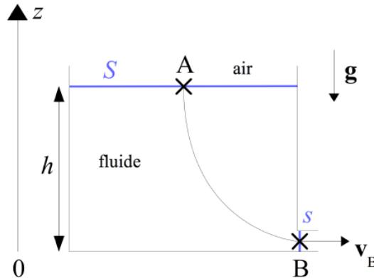
1. Écrire en régime stationnaire l'équation de Bernoulli entre A et B et en déduire la vitesse  $v_B$  de sortie du fluide en fonction de  $g$  et  $h$ . Comme  $s \ll S$ , on supposera  $v_A \approx 0$ .
