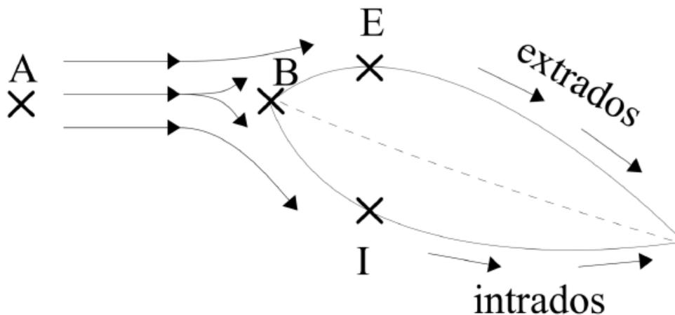
On étudie le comportement d'une aile d'avion en soufflerie (voir Fig. ??). À grande distance de l'aile en A,  $P_A = 10^5 \text{ Pa}$ ,  $v_A = 40 \text{ m.s}^{-1}$ . On considère l'air comme incompressible de masse volumique  $\rho = 1,225 \text{ kg.m}^{-3}$ . On précise que  $g = 10 \text{ m.s}^{-2}$ .
