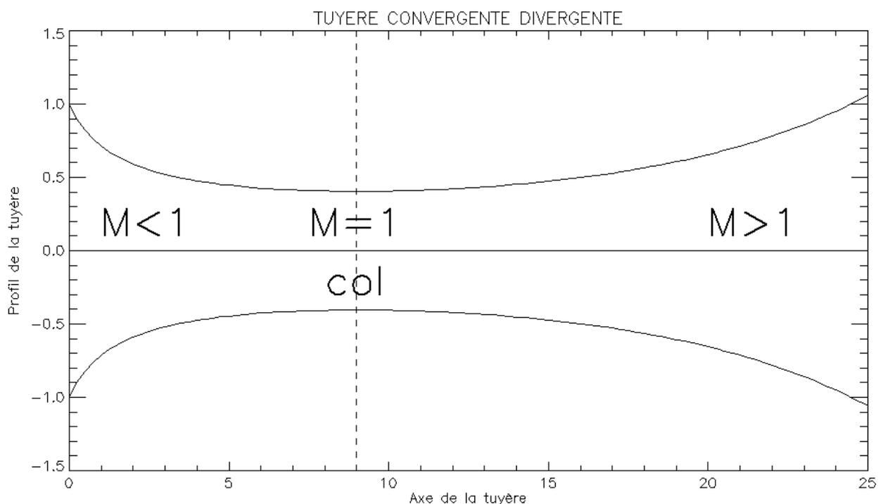
Soit  $x$  l'abscisse d'un point sur l'axe  $Ox$  de la tuyère. Appelons  $S(x)$  sa section (connue) de la tuyère,  $v(x)$  la vitesse de l'écoulement le long de l'axe,  $P(x)$  la pression et  $\rho(x)$  la masse volumique. On se place en régime stationnaire.
