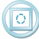
*Figure 25 : Centrage parfait du capillaire de section carrée dans le capillaire cylindrique. Le cercle en pointillés représente la buse obtenue après étirement du capillaire interne de section carrée.*
