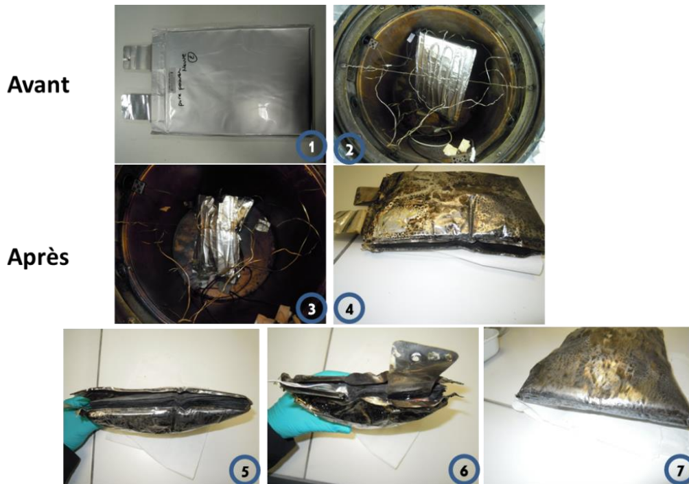
Figure 3.13. Clichés photographiques avant et après essai d'une cellule PurePower (BAT002)
