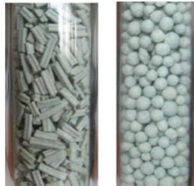
Exemple de chargement de catalyseur extrudé de type trilobes (à gauche) et billes (à droite)
