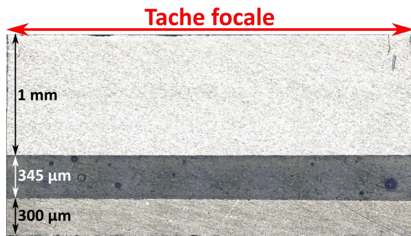
FIGURE 4.17 – Observations au microscope pour 30% de l'énergie maximale du laser.
