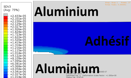
FIGURE 4.39 – Motif d'endommagement pour une énergie laser de 70% de E_{max} , estimé par un critère de Nikiphorovski-Shemyakin, à t = 0.54 \mu s
