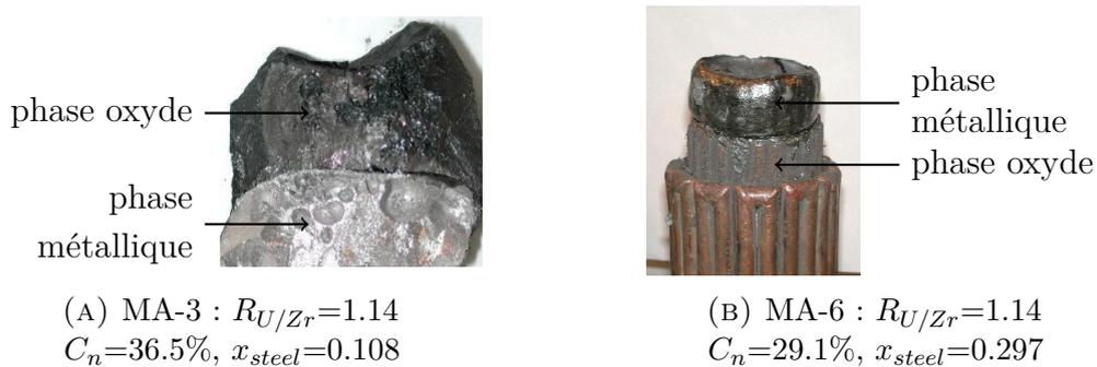
FIGURE 1.7 : Lingots post-mortem des essais MA-3 et MA-6
