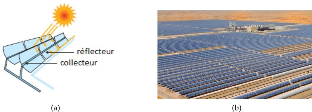
FIGURE 1.10 – (a) Schéma de principe d'un système cylindro-parabolique. (b) Photographie de la centrale solaire thermique SHAMS 1 utilisant la technologie des miroirs cylindro-parabolique.)
