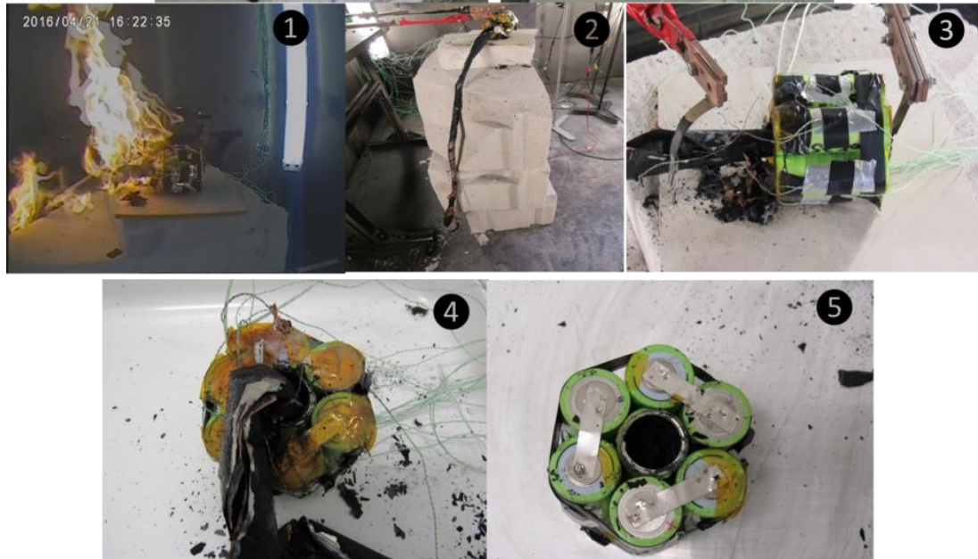
Figure 3.33. Clichés photographiques avant et après essai du module A123s
