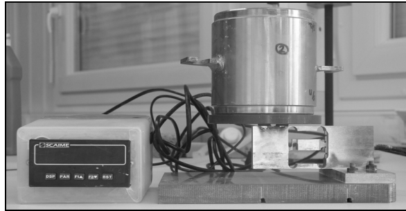
Figure IV-1 : Balance immergeable pour la mesure sous le jet.
