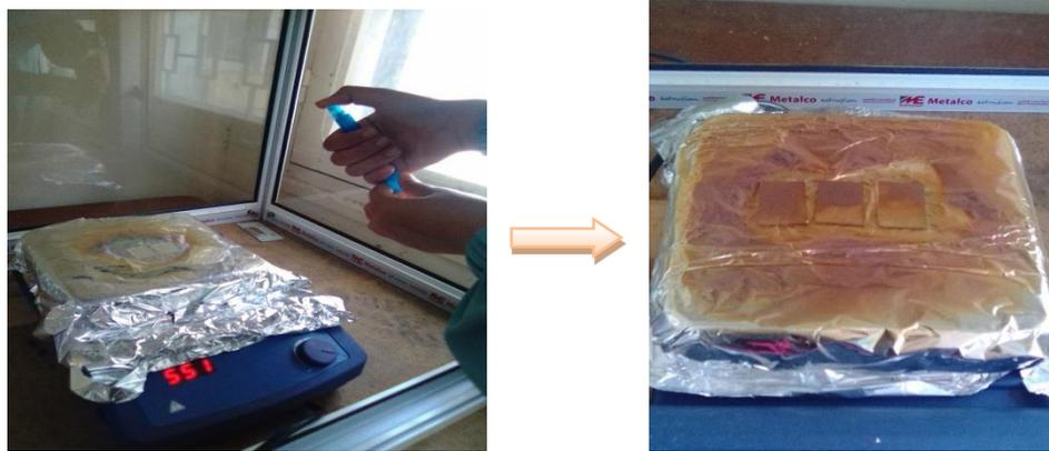
Figure.III.5 : Dépôt des couches mince de SnS.
