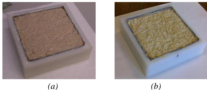
Figure II.6 : Echantillons du mélange chanvre/chaux (a) : à l'état frais, (b) : après séchage.
