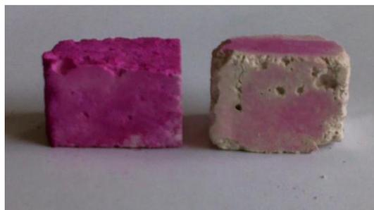
Figure II.9 : Evaluation de la carbonatation des matériaux à l'aide de la phénophtaléine.
