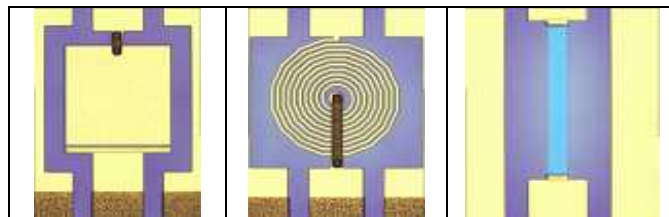
Figure 2-4 : Photographie de composants coplanaires (capacité MIM / inductance / résistance).
