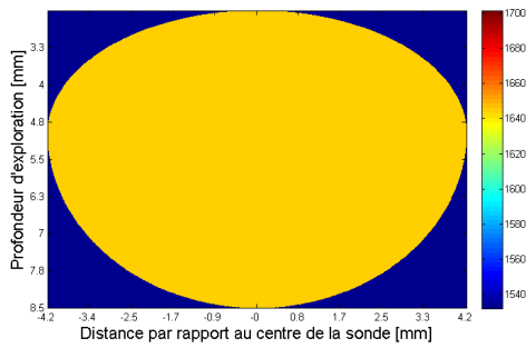
(a) Cartographie de la célérité US pour un cristallin homogène avec c_L = 1645 m/s.
