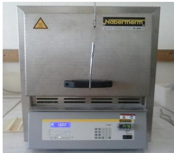
**Figure 12 :** Four utilisée pour le recuit
