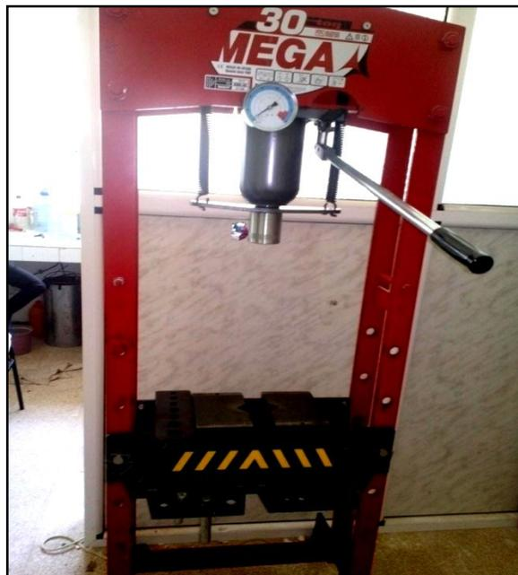
**Fig.III.5 .** Presse hydrostatique utilisée pour pastiller les composés
