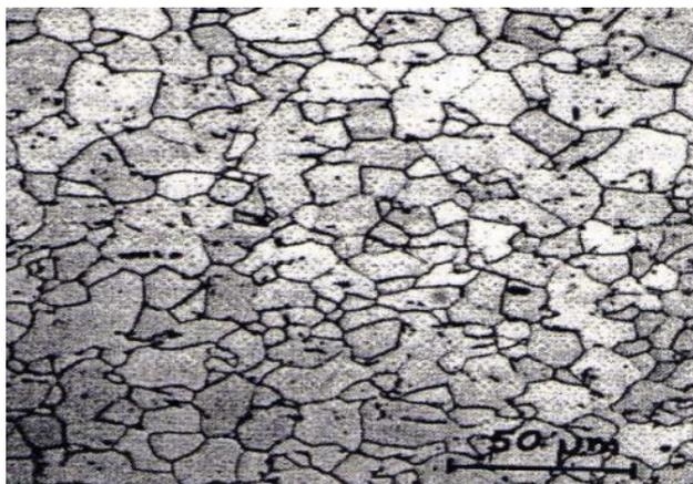
**Figure I.1.** Grains d'un métal observés au microscope optique après attaque chimique.
