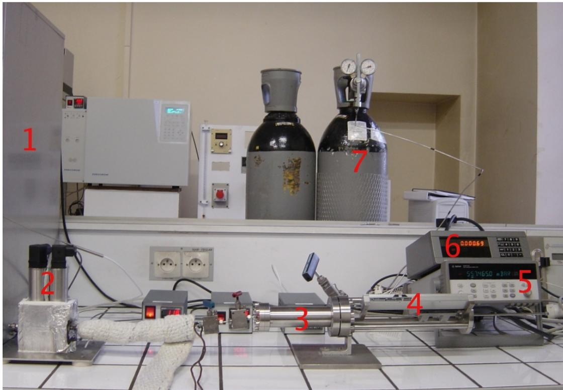
FIG. 2.7 – Vue générale de la ligne d'injection. 1 : enceinte chauffante ; 2 : capteurs de pression ; 3 : presse chauffante ; 4 : règle de déplacement ; 5 : acquisition de la pression et de la température ; 6 : acquisition du déplacement du piston de la presse ; 7 : bouteille d'azote connectée à l'arrière de la presse.
