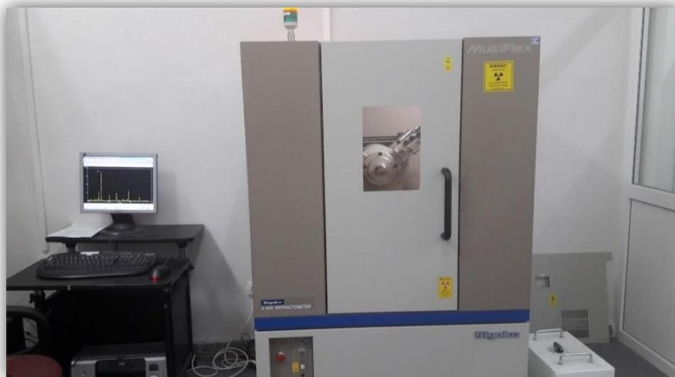
Figure II.6 : Diffractomètre des rayons X.
