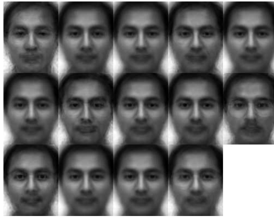
FIGURE 2.2 – Exemple de représentation d’un visage à partir de Fisherfaces, pour un nombre de caractéristiques allant de 1 à 14. Exemple tiré de la documentation en ligne de la librairie OpenCV ( http://docs.opencv.org ).
