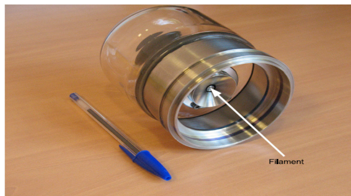
Figure(II.13): Photographie d'un canon à électrons d'un accélérateur de type SL75/5 de Philips[25].
