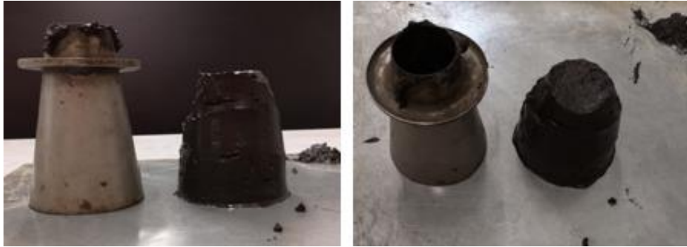
Figure III-12 : Pâte Portland du brevet, faite au MnO_2 , durant la mesure de l'affaissement
