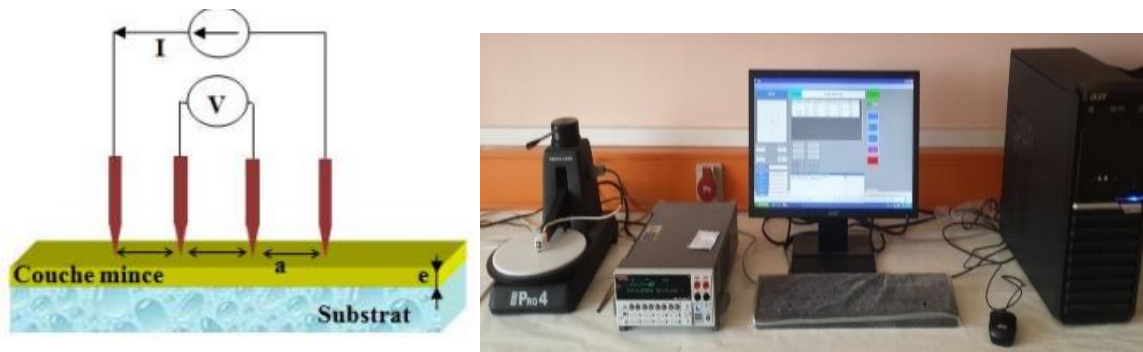
Figure III. 7 photo et Schéma représentatif du principe de la méthode des quatre pointes.
