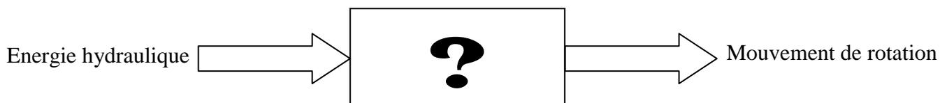
**Solution :** un moteur hydraulique.
