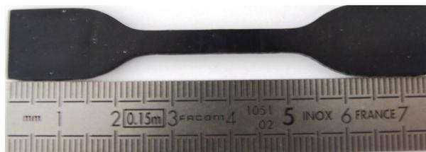
FIGURE 1.21 – Photo d'une éprouvette H2 (Norme ISO 37)
