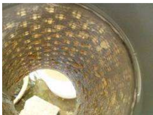
Figure I-16 : Colmatage biologique du filtre en amont de la rampe d'irrigation
