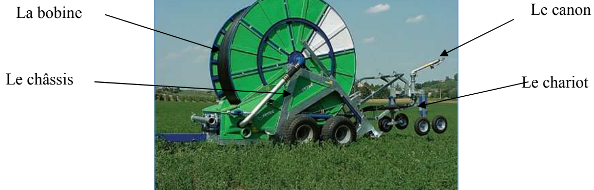
Figure I-4 : les différents composants de l'enrouleur
