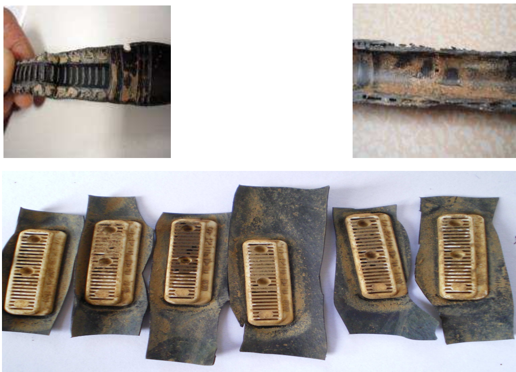
Figure I-15 : Colmatage physique dans le labyrinthe et au niveau de la grille d'entrée située à l'intérieur du tube
