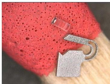
Figure 1.26 – Micro-pince en Alliage à Mémoire de Forme permettant de saisir des micro-lentilles optiques, par Bellouard (2008).
