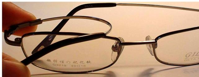
Figure 1.37 – Montures de lunettes utilisant la super-élasticité des Alliages à Mémoire de Forme, par Eyeglasses-online.
