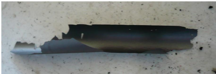
**Figure 32 : Photo du dépôt de carbone pyrolytique obtenu après brossage d'un tube**
