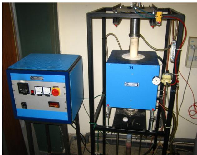
Figure III.6 : Dispositif expérimental de l'appareillage de thermocompression.
