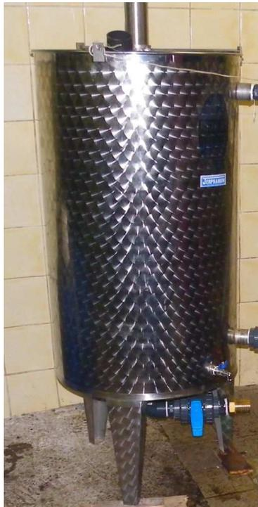
**Figure 13 :** Cuve de décantation en inox
