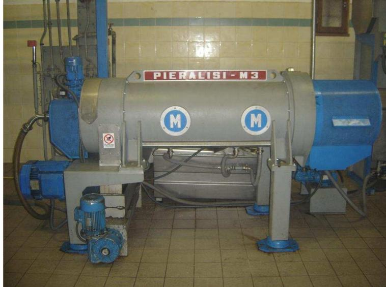
**Figure 9** : Centrifugeuse 3 phases
