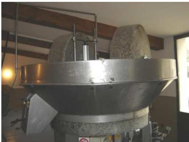
**Figure 2 :** Meule de granit à deux roues
