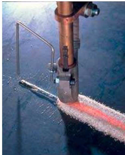
Figure 2-3 : Soudage SAW (sous flux en poudre).
