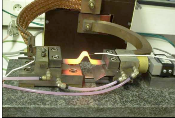
figure 1.4 : Photographie de l'éprouvette de fatigue thermique chauffée par effet Joule
