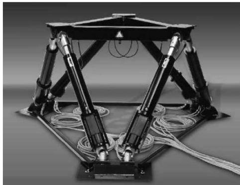
FIGURE 4.2 – Plateforme de Gough-Stewart (source : CAR&D).
