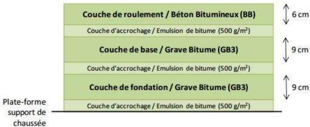
Figure 31 : Les couches d'une chaussée d'une route française [Bio Intelligence Service, 2014]
